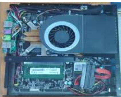
En esta vista se puede apreciar la distribución de los componentes internos, los cuales no permiten una buena refrigeración, el ventilador del procesador no es suficiente para bajar la temperatura del procesador Ryzen 3 2200G de 3.5Ghz que fue entregado con estos equipos y es uno de los mayores problemas que hoy en día se presentan, máxime en las condiciones climáticas que vivimos en el Valle del Cauca.
