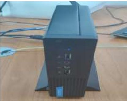
El diseño de la CPU entregado en la orden de compra mencionada anteriormente, no permite que mantenga una correcta refrigeración de los componentes internos, subiendo las temperaturas de estos, lo cual ocasiona que se disminuya su rendimiento, actividad que se ve reflejada cuando un usuario abre más de un archivo de office y se bloquea al realizar búsquedas de información.
