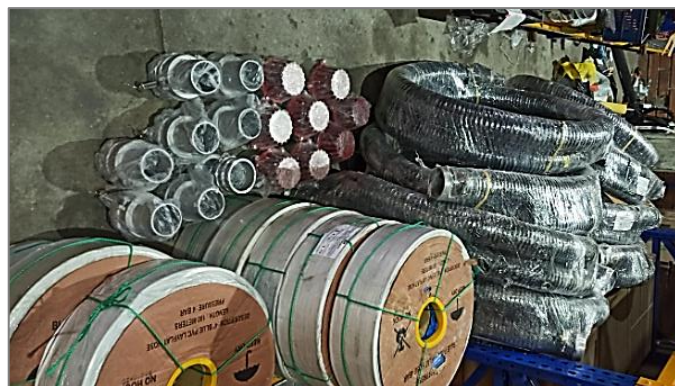
Mangueras de succión y descarga de las motobombas
